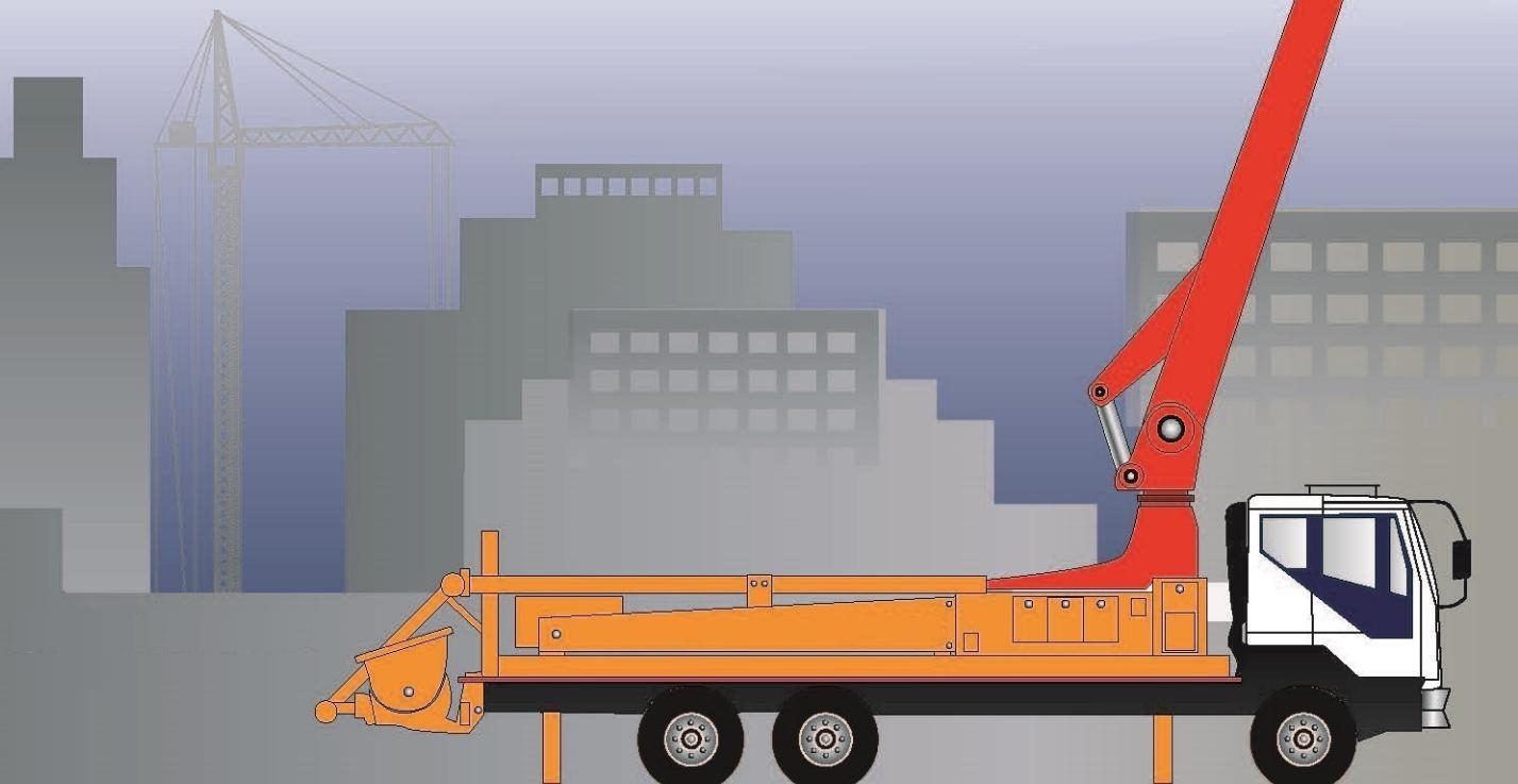
Поскольку автобетононасос является крупногабаритной и достаточно неповоротливой техникой, к месту его установки должен быть обеспечен **свободный подъезд с твердым дорожным покрытием**. Место установки (площадка) автобетононасоса должно быть **ровным и прочным**. Кроме того, размеры площадки должны обеспечивать не только свободный проезд, но и возможность установки гидравлических опор бетононасоса.
